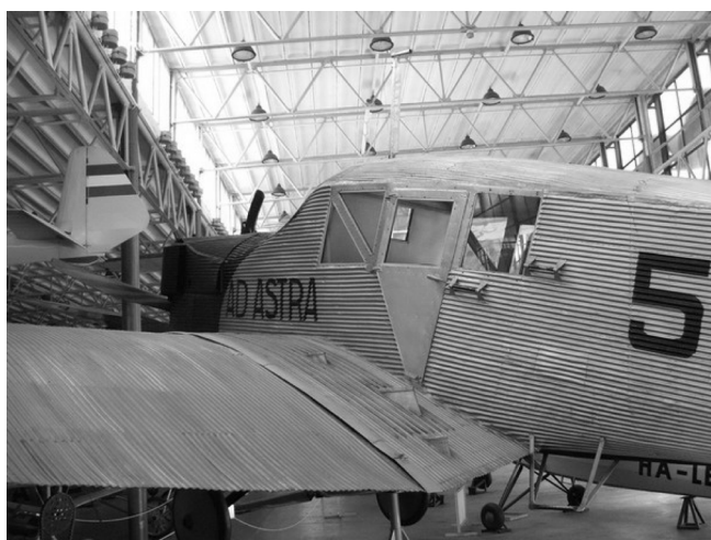
図8 波板状ジュラルミンを使用した全金属製旅客機 Junkers F.13 (©2006 Andi Szekeres) 23)
