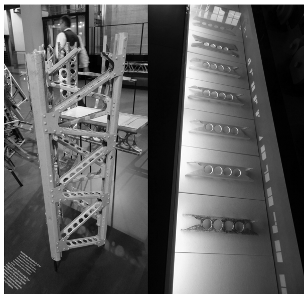
図5 Zeppelin飛行船骨格の一部とフレームのロールフォーミング工程 (FriedrichshafenのZeppelin博物館にて著者撮影)
