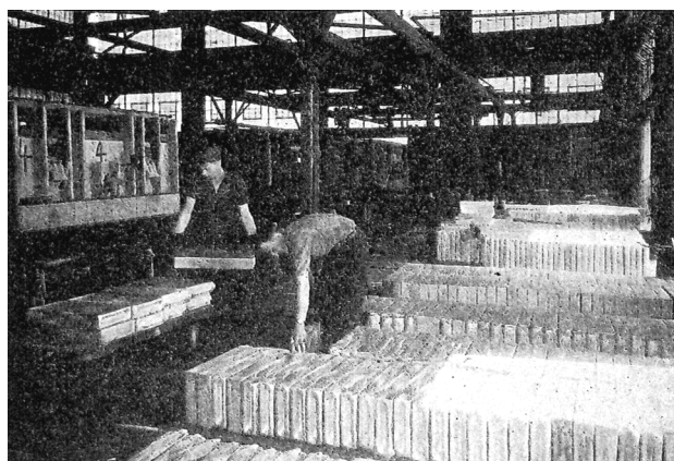
図10 板用インゴットを製造しているAlcoaの鑄造工場 11)
