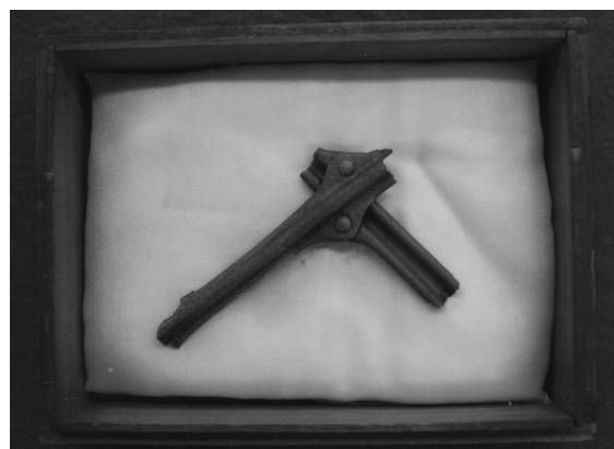
図1 UACJに保管されている英国で撃墜されたZeppelin飛行船の骨材 2),4)
