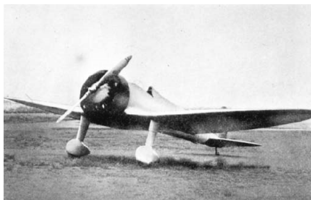
図14 主桁に超ジュラルミンを採用した九六式艦上戦闘機 ( http://www.mhi.co.jp/cats/airplane/photo/presea/96sento.html )
