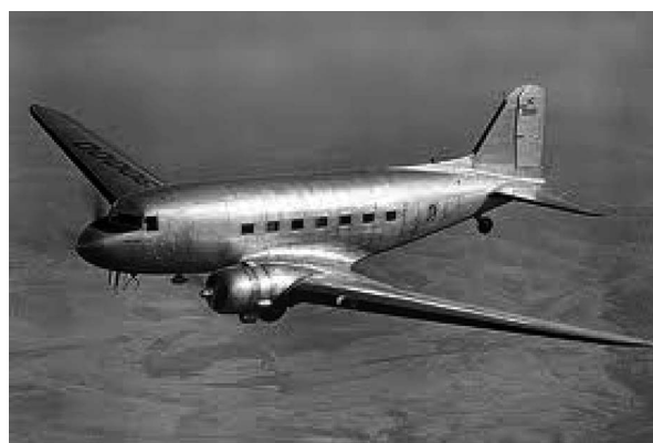
図4 Alclad 24-T3板をスキンに用いたDC-3 10)
