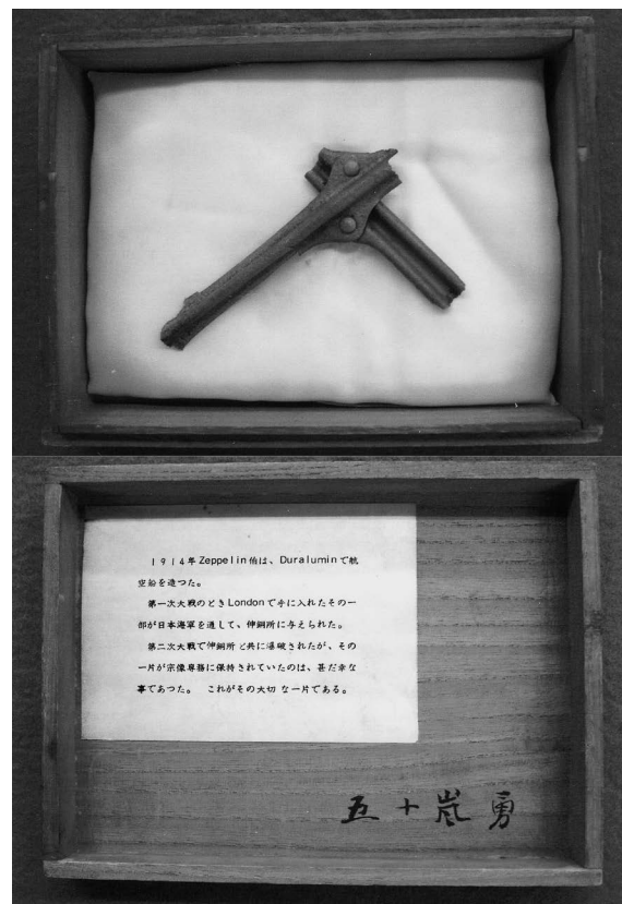
図1 UACJ 技術開発研究所に保管されているツェッペリン飛行船の骨材
