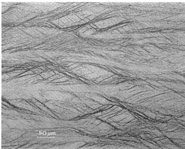
図 33 Al-4.5%Mg 合金の冷間圧延による剪断帯 82)
