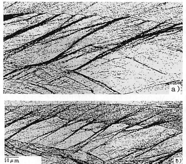
図 36 Al-5%Mg 合金の 70% 冷間圧延材中の剪断帯。(a) 結晶粒界の片側だけに発生した剪断帯, (b) 結晶粒界の両側に発生した剪断帯 85)
