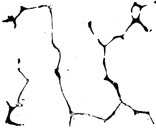
第 105 圖 ゼニラルミンの組織 爐中冷却 硫酸水溶液 \times 100
